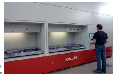
Magazzino automatico Automatic Warehouse
